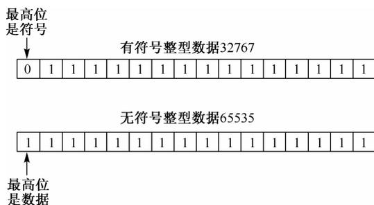
图 1.2.3 有无符号短整型数据的存储情况
