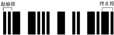
图 2-4 宽度调节法条码符号结构
