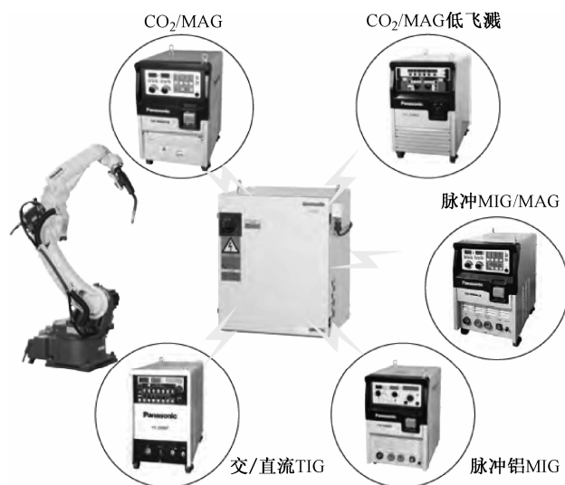
图 1-6 机器人与不同的电源组合图示
