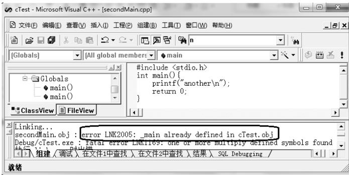
图 1-3-12 多个 main 函数引发的错误
