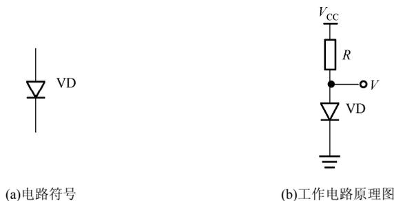
图 2.3.2 二极管的电路符号和正向工作电路原理图
