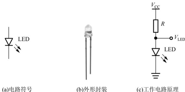
图 2.4.6 发光二极管的电路符号、外形封装和电路原理图
