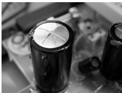
图 5-1-9 已爆裂的电解电容器
