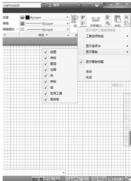
图 2-17 显示和关闭“绘图”面板
