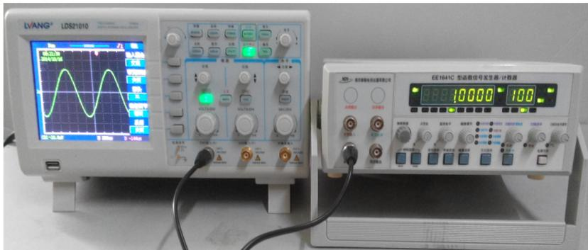
图 2-6 用电子示波器观察信号发生器的输出信号
