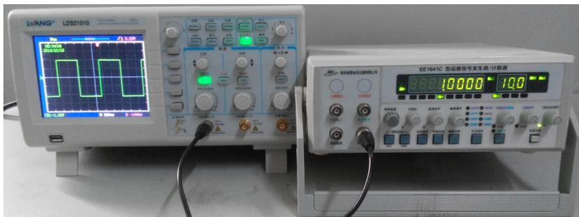
图 2-7 用电子示波器观察信号发生器的输出 TTL 信号
