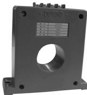
图 5-29 直测式霍尔电流传感器
