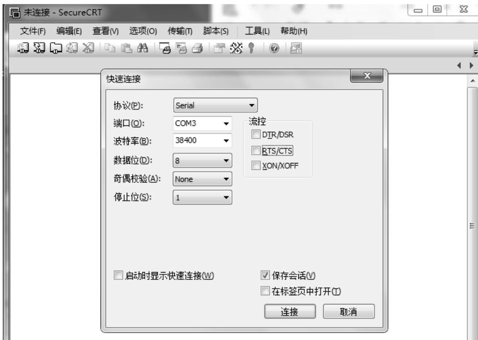
图 4.3.21 串口工具连接设置
