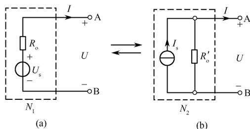
图 2-7 实际电压源与实际电流源的等效变换
