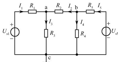
图 2-17 具有多个节点的节点电压法电路
