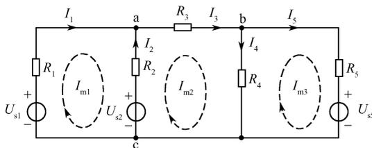
图 2-13 网孔电流法的电路
