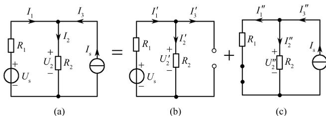
图 2-18 叠加定理的电路
