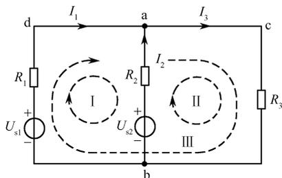
图 2-11 支路电流法的电路
