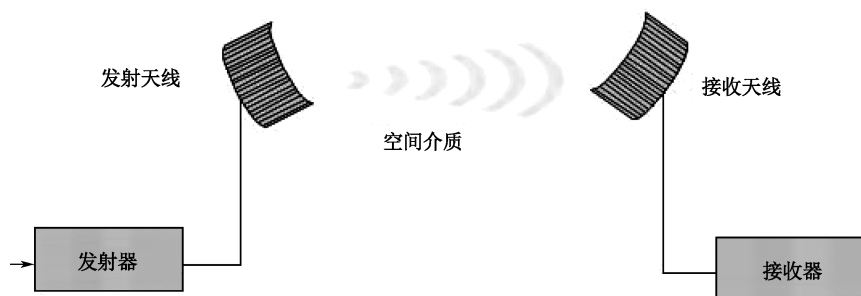
图 1-2-3 天线工作原理
