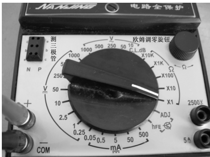
图 1-8 万用表量程开关
