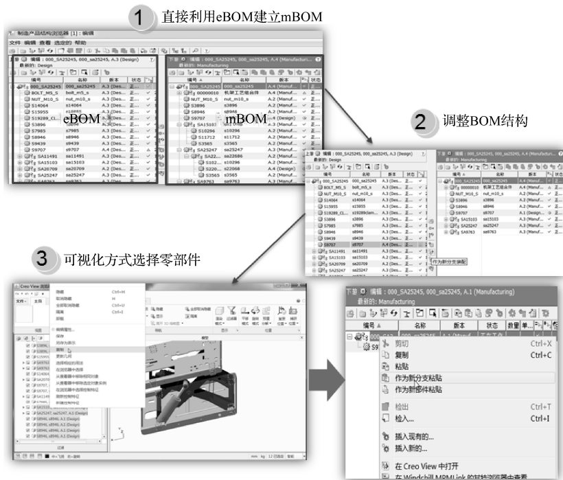
图 1.2.7 eBOM 变换 mBOM 过程
