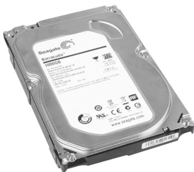
图 1-12 希捷 Barracuda 1TB 7200 转 64MB 单碟硬盘
