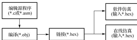
图 1-8 传统的 51 单片机程序开发流程
