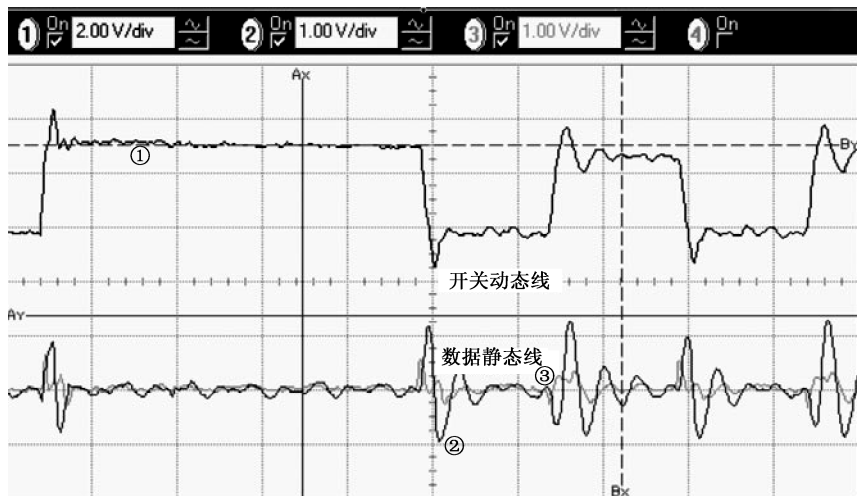
图 1.8 上图对多总线中动态线上测得的电压。下图为两条静态线上测得的噪声,它给出了封装中的动态网络和静态网络之间的互感而产生的开关噪声
