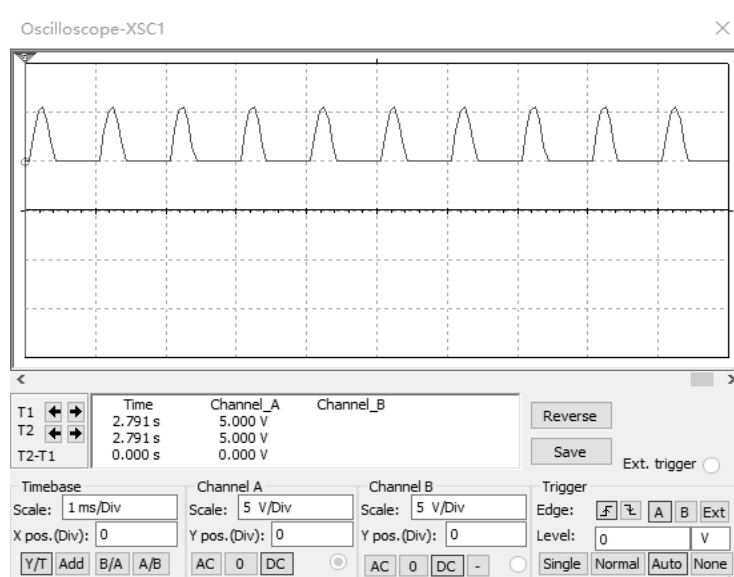
图 1-31 示波器的设置及 u_o 的波形
