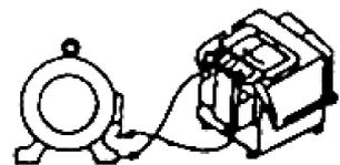
(c) 测量电动机绝缘电阻
