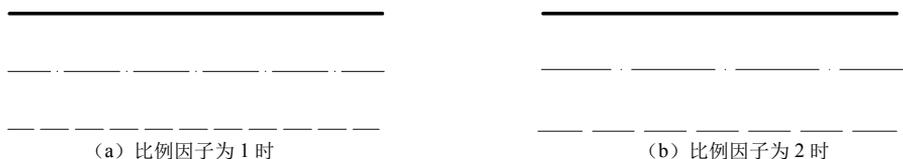
图 1-24 重新设置线型比例因子前、后图形的显示结果
