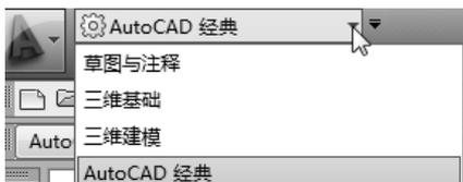
图 1-4 AutoCAD 2012 的 4 种工作空间界面
