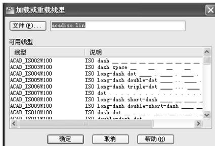
图 1-20 “加载或重载线型”对话框
