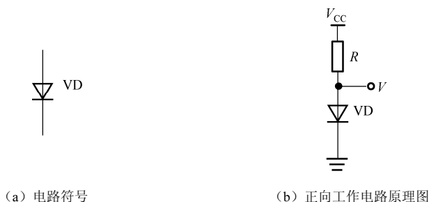
图 1.2 二极管的电路符号及正向工作电路原理图
