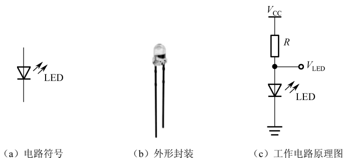
图 1.8 发光二极管的电路符号、外形封装和工作电路原理图
