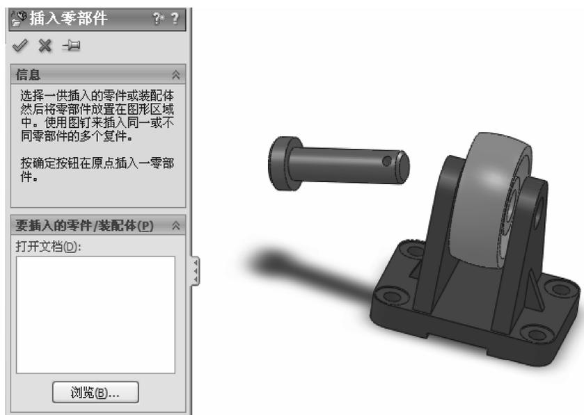
图 3.4 装配零件轴的插入
