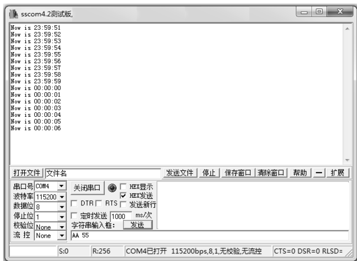
图 3-3 串口电子钟实验结果
