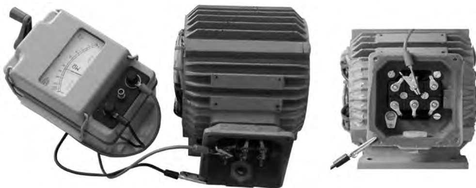
图 1-1-13 测量绕组对地绝缘
