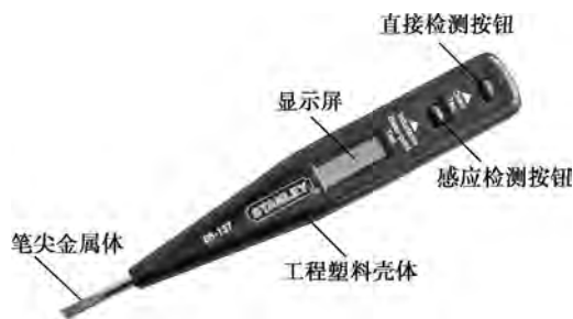
图 1-2-3 数字式验电笔结构
