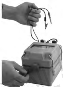
图 1-1-11 绝缘电阻表开路检验
