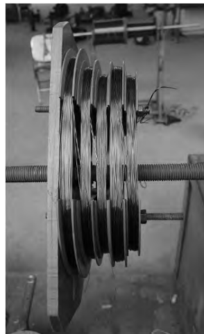
图 1-3-22 线圈绕制现场照片
