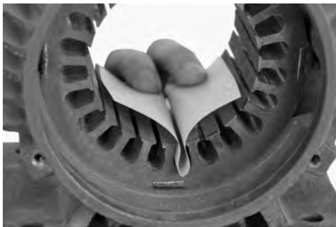
(a) DMD 绝缘纸用于槽绝缘
