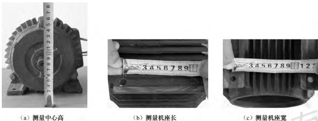
图 1-3-34 测量电机空壳的外形尺寸
