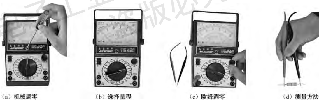
图 1-1-10 用万用表测量电阻
