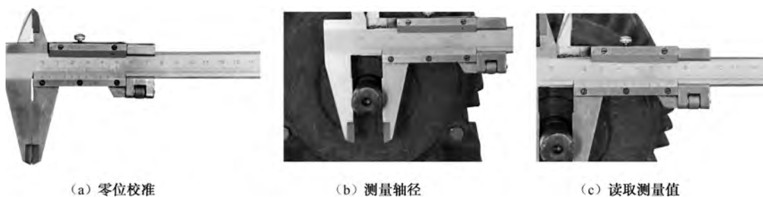
图 1-3-35 测量电机转轴的直径
