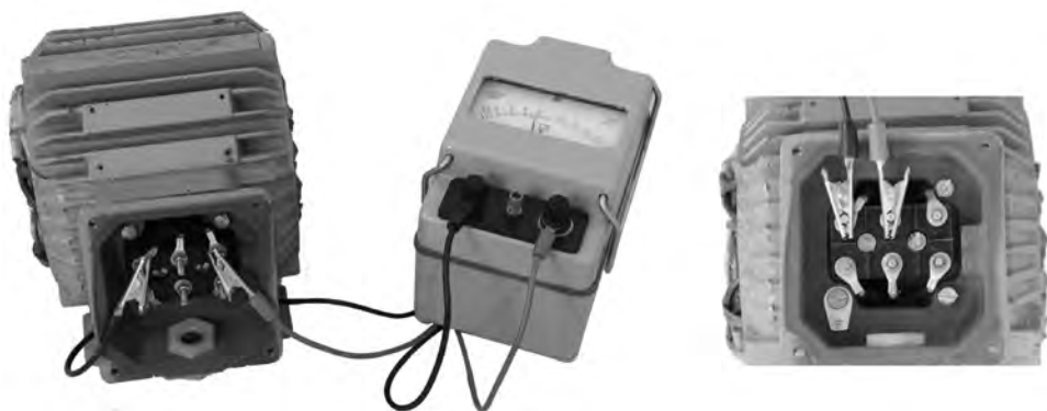
图 1-1-14 测量绕组相间绝缘
