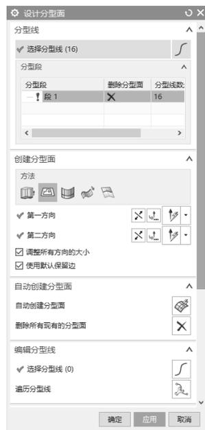
图 3-15 “设计分型面”对话框
