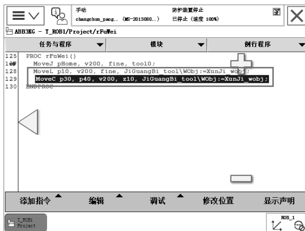
图3.8 圆弧运动指令结构
