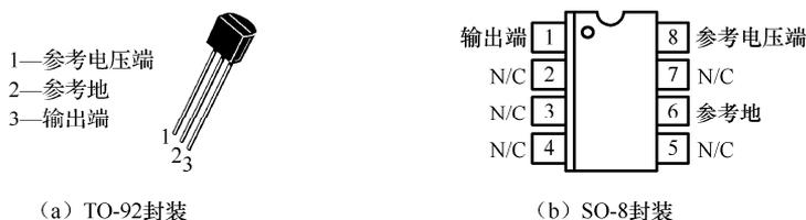
图 3.23 集成电压基准源 TL431 的引脚封装图
