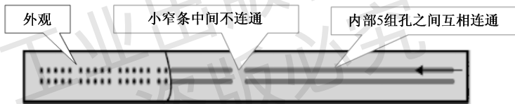
图 1.4.2 面包板窄条结构示意图
