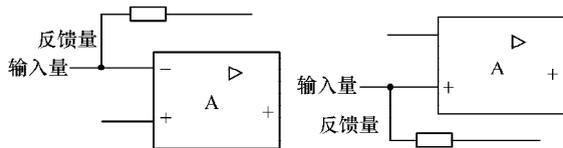
图 3.2.6 并联反馈运放电路
