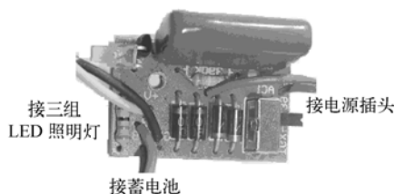
(b) 充电器和开关电路实物图
