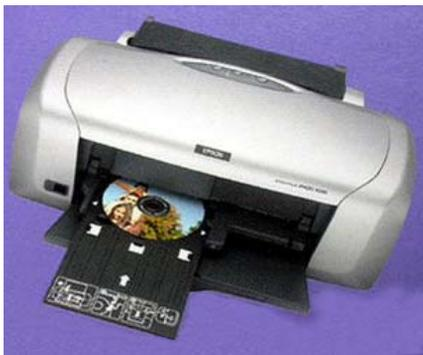
图 2.45 打印盘面时打印机工作状态
