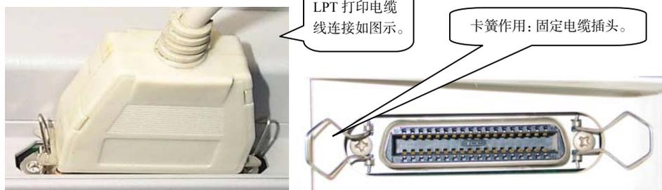
图 2.11 LPT 打印电缆线连接及卡簧作用
