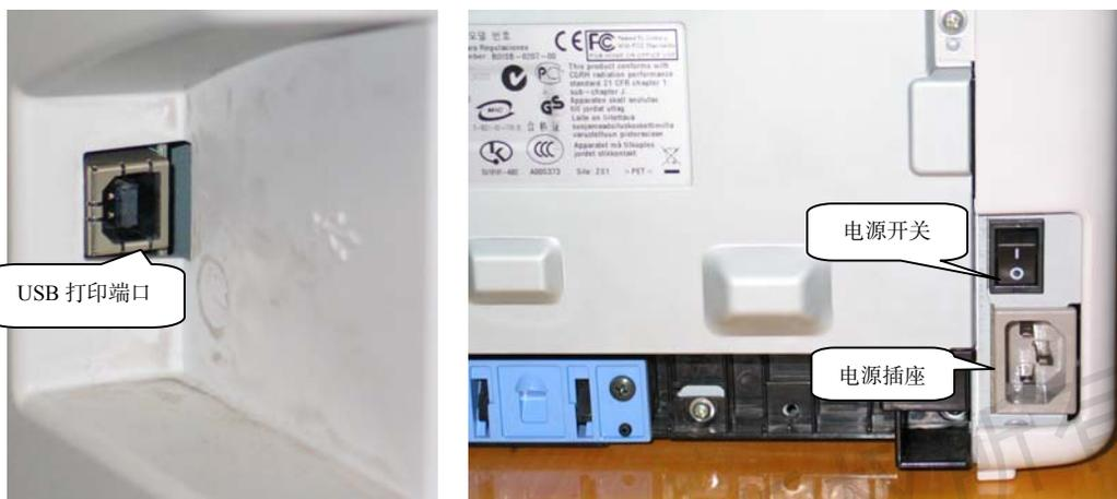
图 2.19 打印机背面结构
