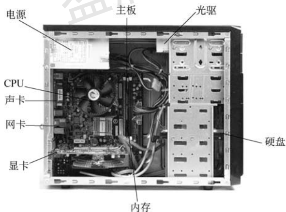
图 3-7 微机的机箱内部结构
