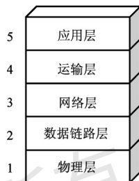
图 1-15 具有五层协议的计算机网络体系结构
