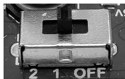
图 1-5 处于“1”位状态的三位开关
