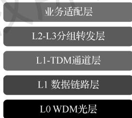
图 2.1 5G 承载网的分层结构
