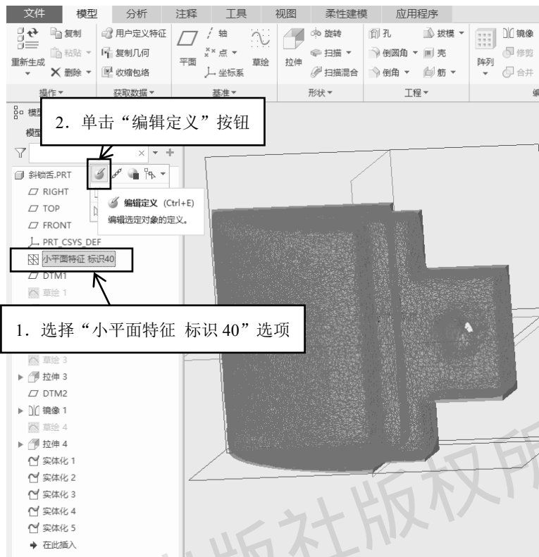
图 1-1-44 进入小平面编辑界面的操作步骤
