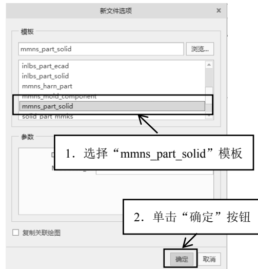
图 1-1-3 在对话框中进行零件配置的操作步骤
