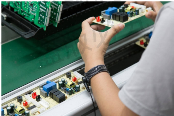
图2-3 办公人员佩戴防静电手环检测电子设备
