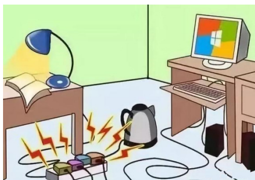
图 2-1 电源转换器过度使用
