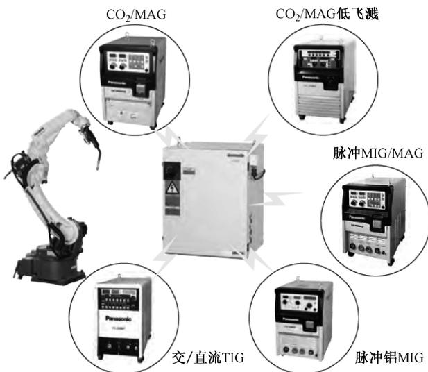
图 1-6 工业机器人与不同的焊接电源组合图示
