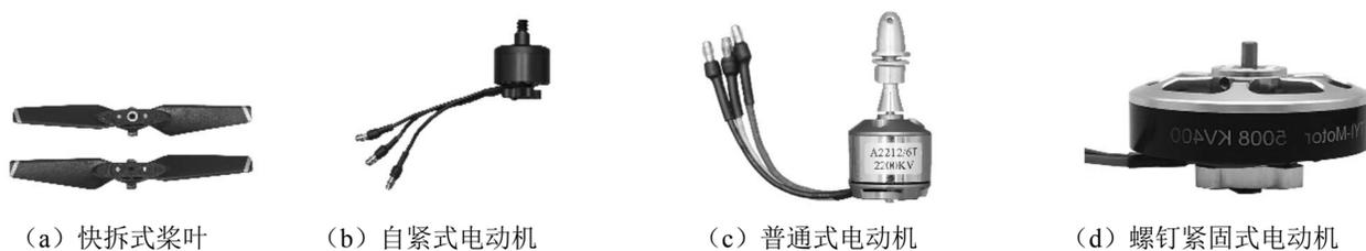
图 1-2-13 常用螺旋桨固定方法涉及的相关部件
