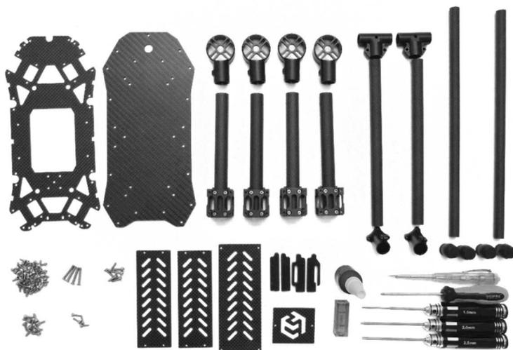
图 1-1-11 多旋翼无人机飞行平台组装调试的物料
