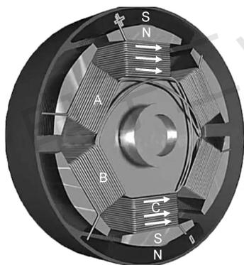
图 1-2-5 无刷电动机工作原理图
