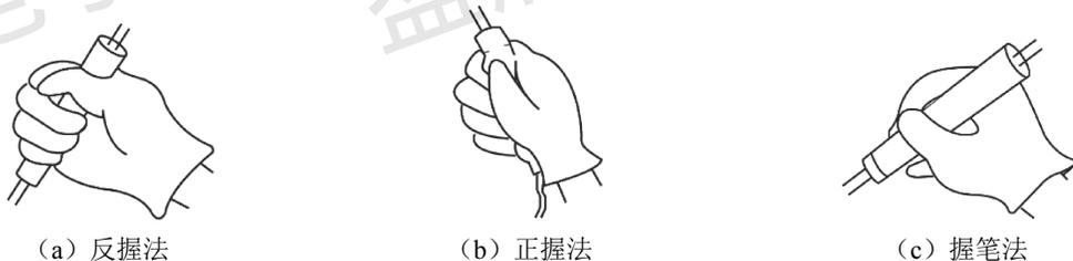
图 1-2-21 电烙铁的握法
