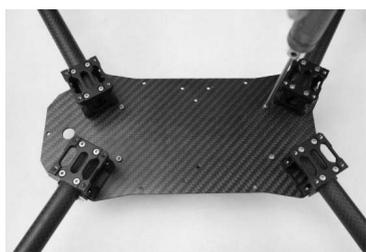
图 1-1-15 将电池仓固定到下中心板下方
