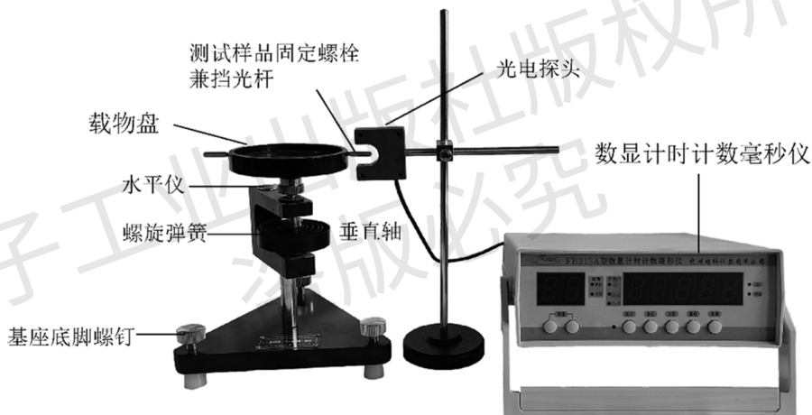
图 3.4-1 智能转动惯量实验仪的结构
