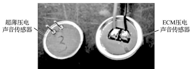
图 3-20 压电驻极体声音传感器示意图
