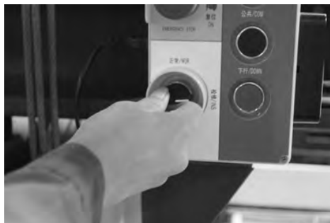
图 3-23 复位轿顶检修开关
