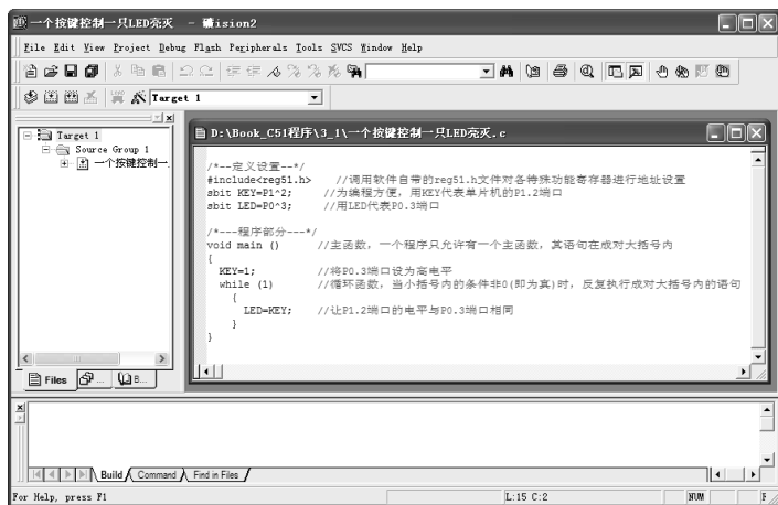
图 3-10 在 Keil 软件自带的程序编辑器中用 C 语言编写程序
