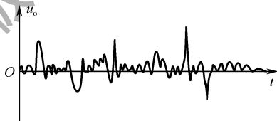
图 3.9 噪声电压波形
