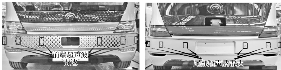
图 3-1 小宇车上的超声波雷达
