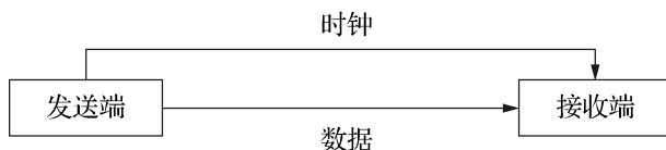
图 3-12 引导时钟方式示意图
