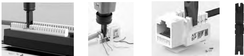
图 3-5 110 打线刀使用方法
