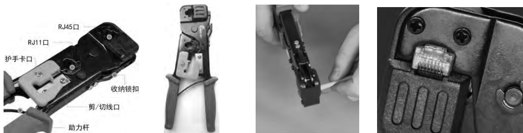
图 3-3 双用网线钳和的使用方法
