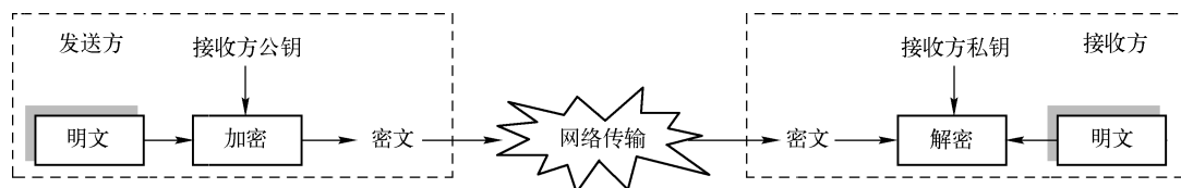
图 3.23 非对称密码体制的加密模型
