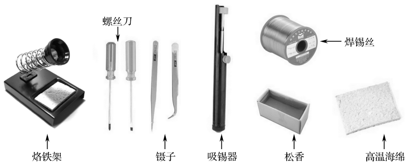
图 1-27 电路手工焊接辅助工具
