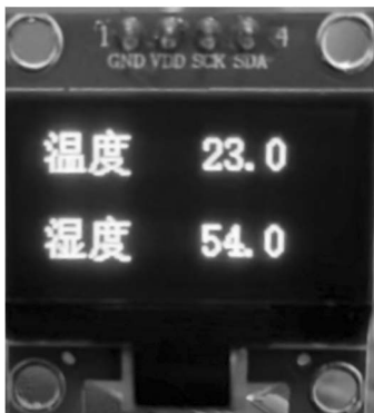
图 3-23 OLED 屏显示温湿度数据的效果
